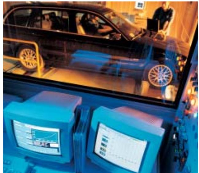
Nell'ambito della ricerca e sviluppo con l'ausilio di una moderna sala esperienza, vengono simulate le condizioni di funzionamento su strada e quindi perfezionate le strategie di calibrazione delle centraline elettroniche che sono il cuore dei sistemi ad iniezione; settore nel quale la Tartarini Auto ha ottenuto i più alti riconoscimenti di omologazione e certificazione in campo internazionale.
